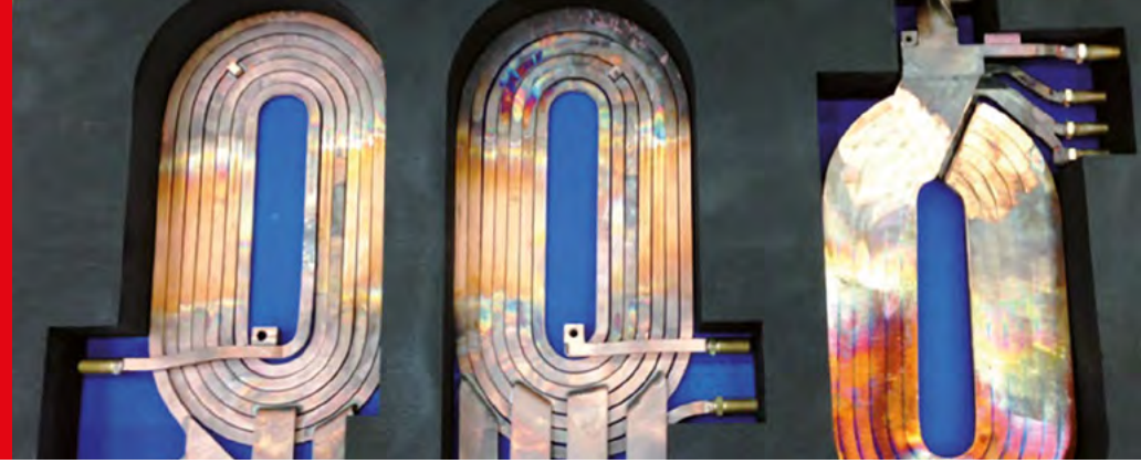
Innerbetriebliche Lagerung und Transport von Induktionsspulen in einem Schaumstoffpolster
